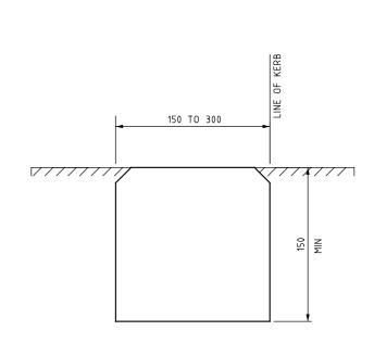
B TYPE SPIKED BARRIER KERB FOR TEMPORARY WORKS
